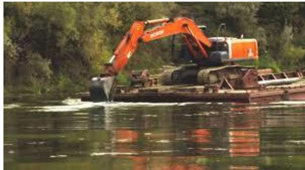
*Fig. 4 – 5, esempi di escavatore operante su pontone*
